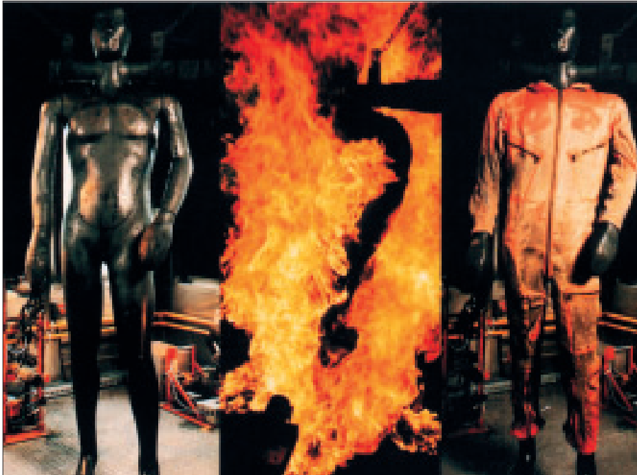
Abb. 1. Thermo Man ist die Prüfpuppe der Firma Du Pont. Sie besitzt 79 Messpunkte und wird für Tests an Kleidungsstücken eingesetzt.
